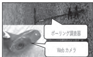
図2 簡易ボーリング調査器
